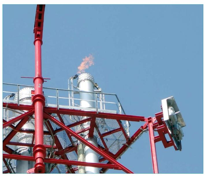
На первой террасе комплекса АКМ в цехе аммиака по разработанной программе продолжаются пусконаладочные работы (ПНР). 24 августа состоялся розжиг первой запальной горелки на факеле зоны синтеза аммиака (на фото).
