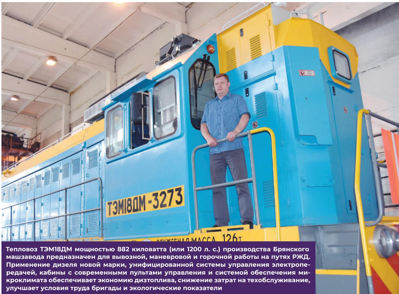
Тепловоз ТЭМ18ДМ мощностью 882 киловатта (или 1200 л. с.) производства Брянского машзавода предназначен для вывозной, маневровой и горочной работы на путях РЖД. Применение дизеля новой марки, унифицированной системы управления электропередачей, кабины с современными пультами управления и системой обеспечения микроклимата обеспечивает экономию дизтоплива, снижение затрат на техобслуживание, улучшает условия труда бригады и экологические показатели
