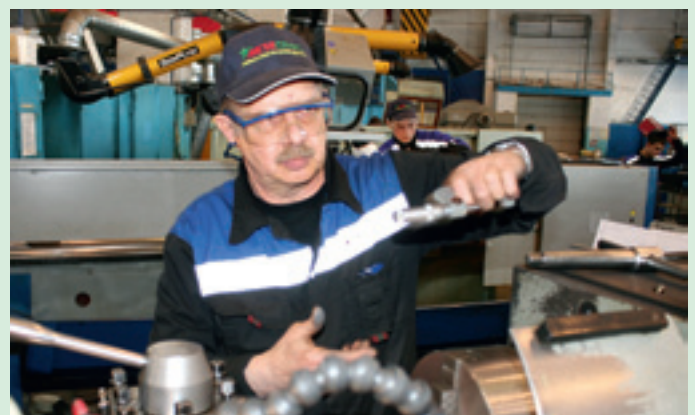
Токарь Сергей КОТОМЦЕВ производит замер детали для последующей обработки
