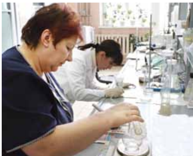
Лаборанты Галина БЕЛКИНА и Тамара ДЖОХАДЗЕ определяют температуру каплепадения новолачной смолы. Это важный показатель её качества
